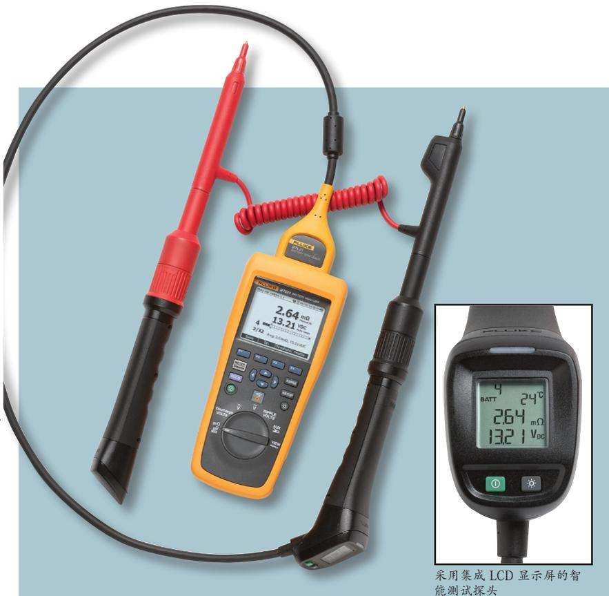
采用集成 LCD 显示屏的智能测试探头
